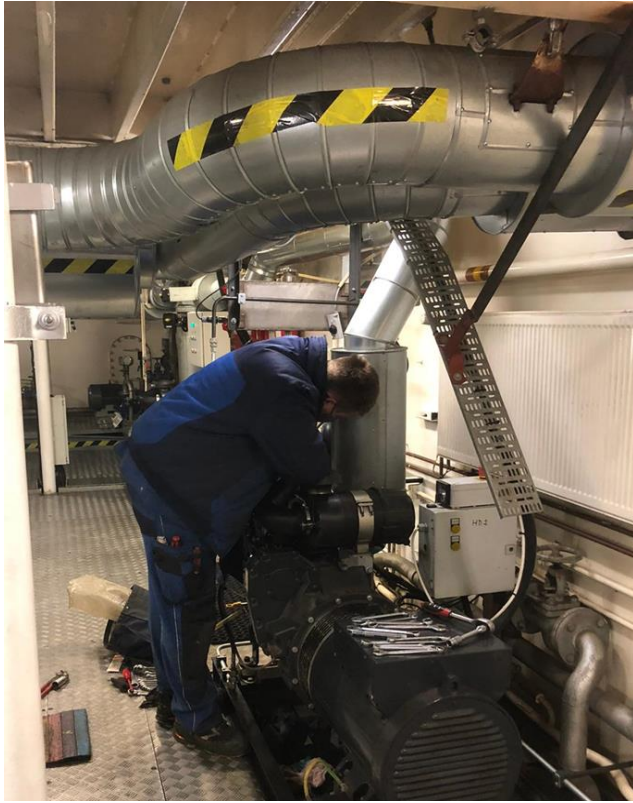
Christoph Abel und Rony Gehrman Wartung/Revision Hauptmaschine und Hilfsdiesel MF Wittow
