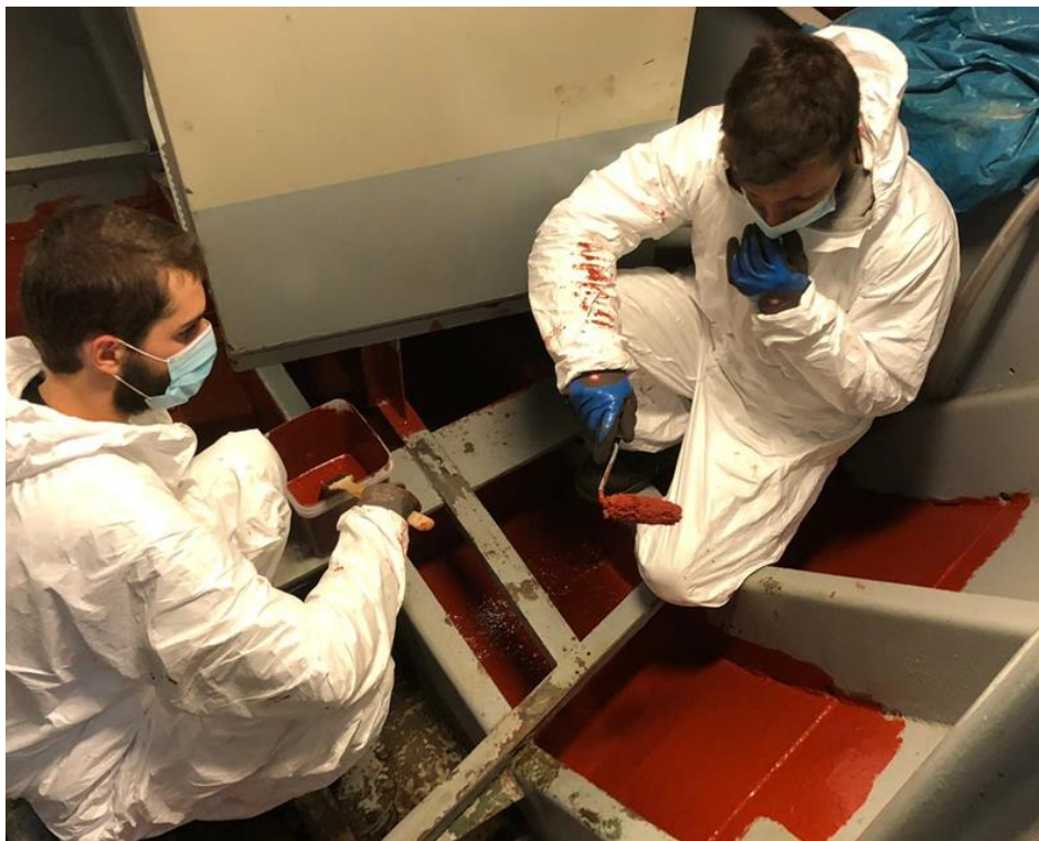
Auszubilde Friedemann Goerig (l) und Jannes Kreibohm (r) bei der Bilgenkonservierung auf MS Sundevit
